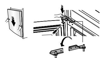
15 Вставьте верхнюю дверь на место и зафиксируйте верхнюю петлю (2) саморезами (1). Для моделей холодильника с дисплеем на двери не забудьте пропустить электрический разъем (3) в отверстие верхней петли (2) и лишь затем прикрутите петлю. (При этом крепко придерживайте верхнюю дверь руками).
