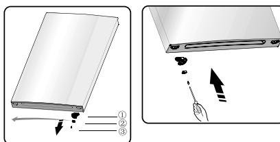
8 Ослабьте шурупы/болты, которые фиксируют среднюю петлю, и снимите среднюю петлю. Затем снимите нижнюю дверь.
