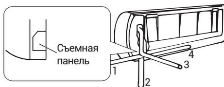
трубопровод отсутствует, присоедините трубопровод хладагента внутреннего блока к трубопроводу, соединяющему внутренний и наружный блоки. Подробные инструкции приведены в разделе «Соединение трубопровода хладагента» данного руководства.
