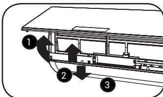
**⚠ Производите очистку фильтра каждые две недели при эксплуатации прибора в загрязненном помещении.**
