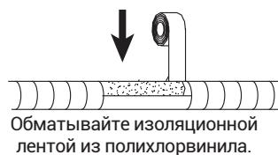
Обматывайте изоляционной лентой из полихлорвинала.
