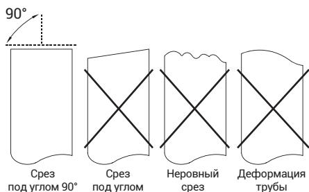
2 С помощью развертки или инструмента для снятия заусенцев удалите все заусенцы с места разреза трубы.
