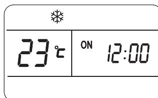
**⚠ Примечание:** если Вы не начали установку времени после нажатия кнопки TIMER ON в течение 10 секунд, то режим установки таймера автоматически отключится.
