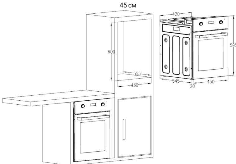
3. Прикрепите духовой шкаф к кухонной мебели с помощью двух шурупов, пропустив их через отверстия в его раме.
