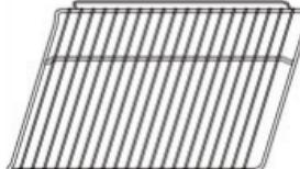
**Боковые направляющие:** эти опорные боковые направляющие устанавливаются с правой и с левой стороны внутри духового шкафа; их можно снимать для очистки стенок духового шкафа.
