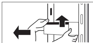
Для перемещения полки поднимите заднюю часть полки и потяните на себя.
