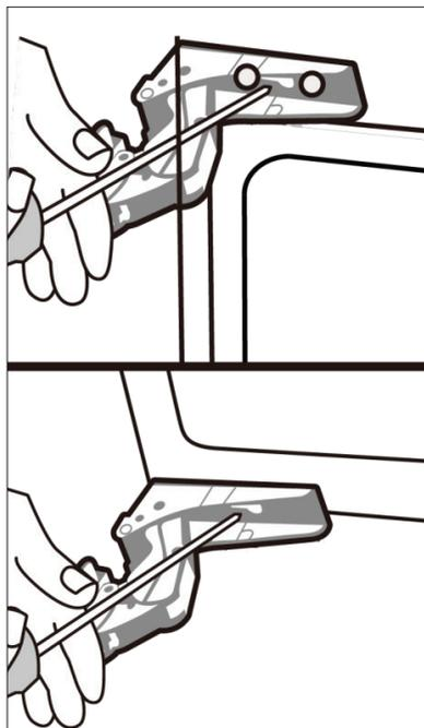
4. При открытой верхней петле открутите фиксирующие саморезы и отсоедините петлю от устройства
