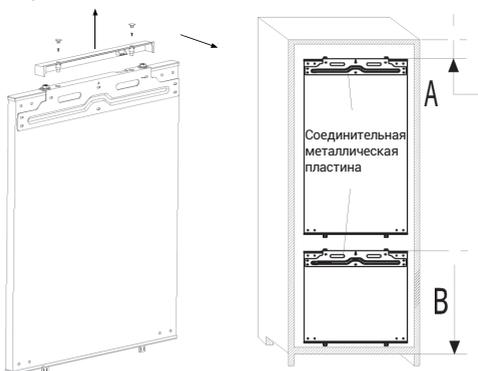
Снимите соединительную металлическую пластину и смонтируйте её в деревянную дверь.
