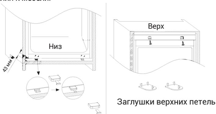
Р.С. Пожалуйста, уберите хвостовик после фиксации крышки в нижней части.
