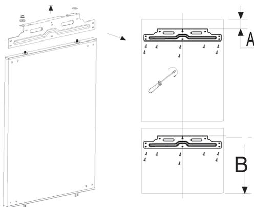
Следуйте указаниям ниже, чтобы соединить деревянную дверь и дверь холодильника.
