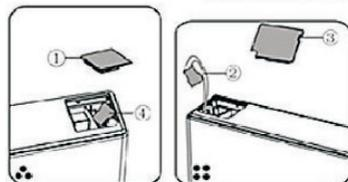
7 Ослабьте шурупы/болты (3) и снимите ограничительный блок (2) и фиксатор двери (1). Установите фиксатор двери левый (4) (находится в пластиковом пакете) и ограничительный болт (2) на левую сторону двери с помощью шурупов/болтов (3). Сохраните фиксатор двери правый (1) для будущих целей.
