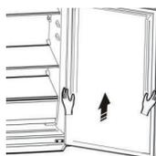
5 Для моделей холодильника с дисплеем на двери возьмите накладку для отверстия для винта правую из пластикового пакета и установите на правую верхнюю часть корпуса холодильника. Затем снимите накладку для отверстия для винта левую с левой верхней части холодильника и положите её в пластиковый пакет. Для моделей холодильника без дисплея снимите и переставьте накладку для отверстия для винта с левой стороны на правую и зафиксируйте её.
