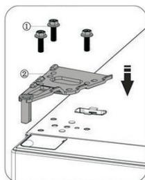
16 Подсоедините электрический разъем (1), как показано на рисунке ниже, затем зафиксируйте накладку верхней петли (2) с помощью саморезов (3).
