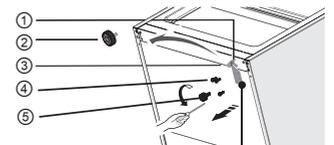
13 Переставьте часть нижней петли (1) с правой на левую сторону и закрепите её с помощью саморезов (4). В самом конце вставьте регулируемую ножку (2).
