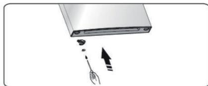
6. Придерживая дверь морозильной камеры руками, с помощью шестигранного ключа (4 мм), поставляемого в комплекте с холодильником, выкрутите винты, фиксирующие правую среднюю петлю, и снимите ее. Приложите небольшое усилие и поднимите дверь вверх, чтобы снять ее с нижней петли. Расположите снятую дверь на мягкой поверхности фронтальной панелью вверх.
